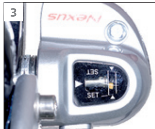
Ist die rote Markierung nicht sichtbar, muss geprüft werden, ob sich die gelbe Markierung zwischen den beiden weißen Linien befindet.
